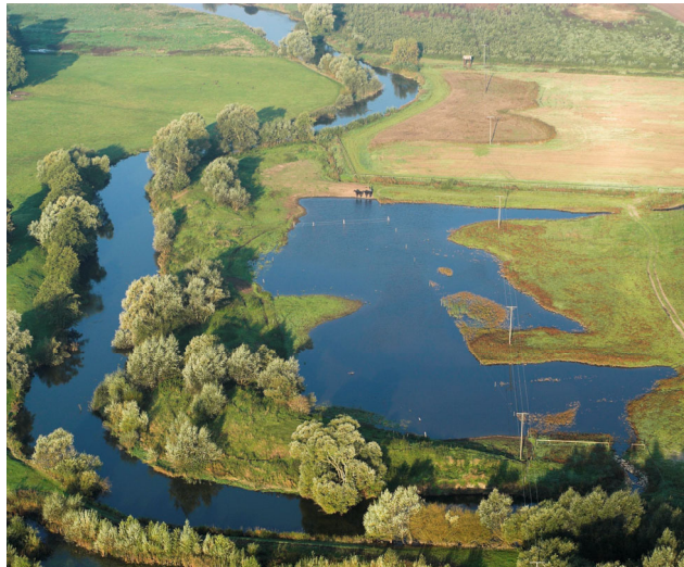
Figur 3. Anlagd damm vid Hammarlunda, Eslövs kommun. Dammen tar emot vatten från ett mindre biflöde innan det leds ut i Kävlingeån.
