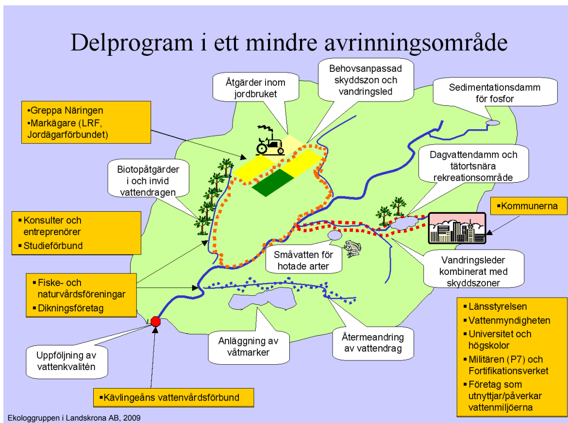
Figur 2. Illustration av åtgärdsförslag inom ett fiktivt mindre delavrinningsområde. De orange boxarna illustrerar möjliga aktörer och i "pratbubblorna" återfinns åtgärdsförslagen.
