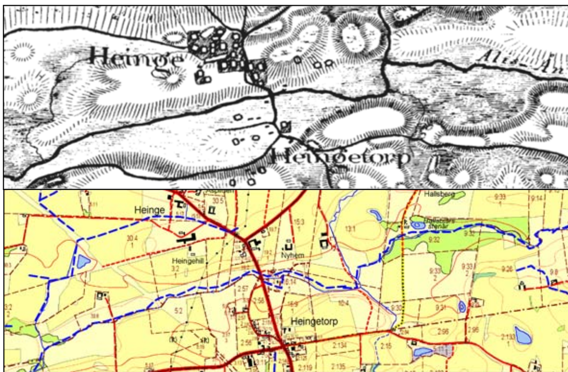
Figur 16. Ån som rinner genom Heinge i Sjöbo kommun har sannolikt sänkts genom ett dikningsföretag. De fuktiga ängarna kring ån är idag betesmarker och en höjning av vattennivån skulle kanske försvåra möjligheten att hålla området öppet via bete. Utsnitt från Skånska rekognoseringskartan 1820 (övre) och samma område på dagens fastighetskarta.
